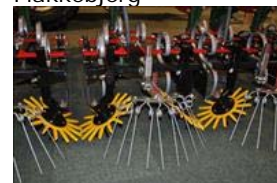
Fingerhjul af gummi kan løsne en del af ukrudtet inde i rækken. Foto: Thyregod A/S
