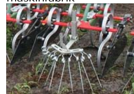
Efter friskæring af ukrudt ryster efterharven jord af planterne og trækker dem op til udtørring. Foto: Thyregod A/S
