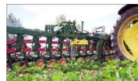
Optisk styring af radrenseren foretages af to kameraer monteret forrest. Foto: Thyregod A/S
