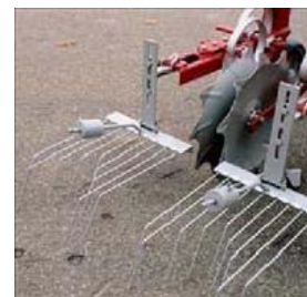
Efterharven løsner jorden fra rødderne af ukrudtet Foto: Kongskilde maskinfabrik
